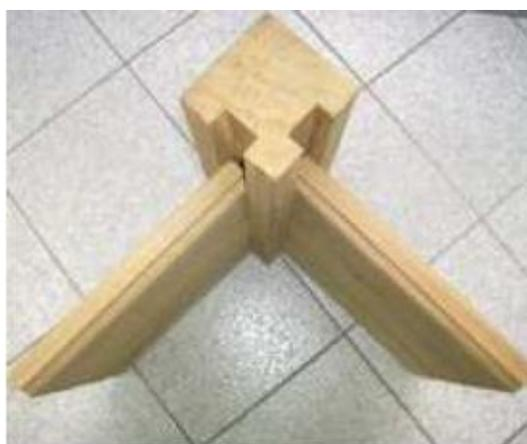
Encaixe macho-fêmea do pilar com a parede simples
