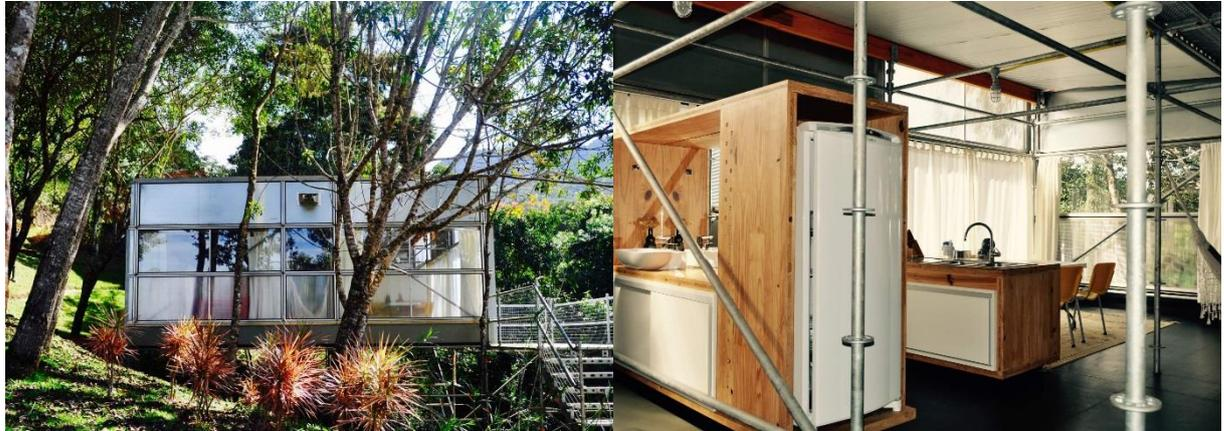
Residência construída em 2013 em Prados - MG. Estrutura externa em andaimes multidirecionais e fechamento com placas de alumínio e policarbonato. Todas as divisórias internas, incluindo bancadas e alguns mobiliários, foram executadas em CLT
