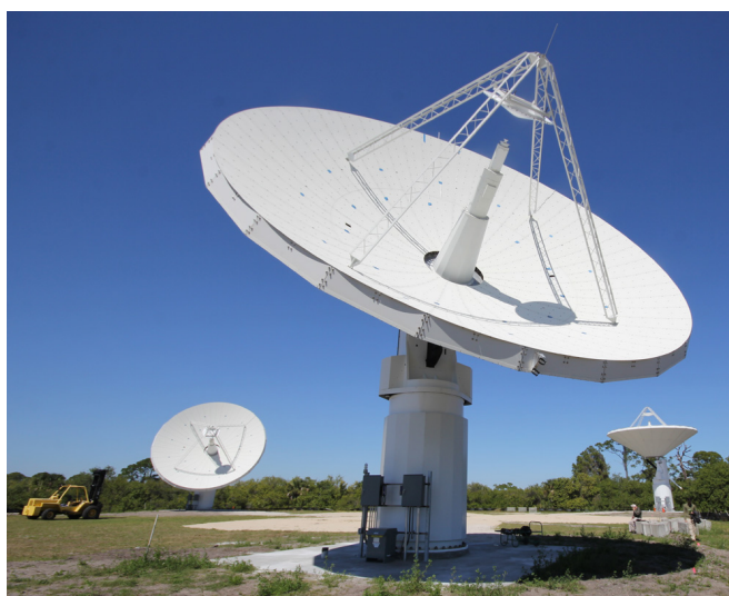
Figura 2.5: Antena parabólica utilizada num radar para detecção de asteroides
