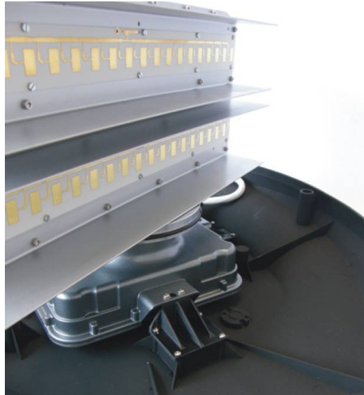
Figura 2.6: Patch Antenna Array de um FMCW radar marítimo
