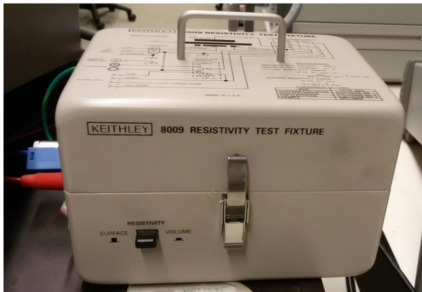
Figura 65 - Equipamento *Resistivity Test Fixture 8009* da *Keithley*.
