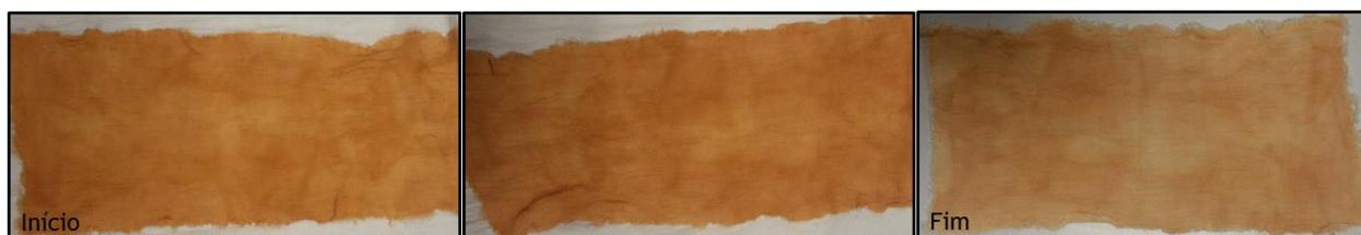
Figura 30 - Amostra de lã tingida com lama C a 10 g/L pH neutro antes e após lavagens.
