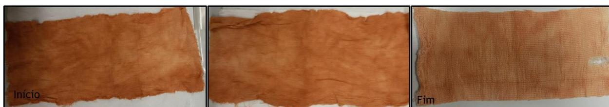
Figura 25 - Amostra de lã tingida com lama D a 10 g/L pH neutro antes e após lavagens.
