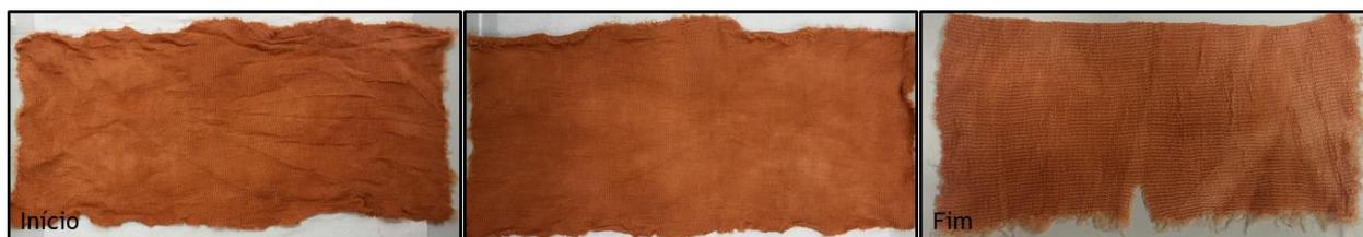
Figura 27 - Amostra de lã tingida com lama D a 50 g/L neutro antes e após lavagens.
