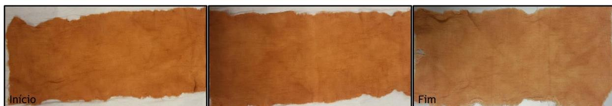
Figura 31 - Amostra de lã tingida com lama C a 50 g/L pH ácido antes e após lavagens.
