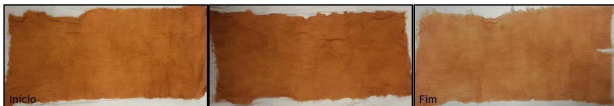
Figura 32 - Amostra de lã tingida com lama C a 50 g/L pH neutro antes e após lavagens.
