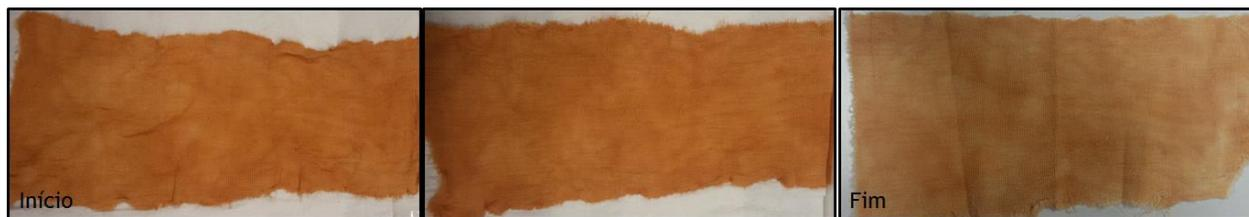
Figura 29 - Amostra de lã tingida com lama C a 10 g/L pH ácido antes e após lavagens.
