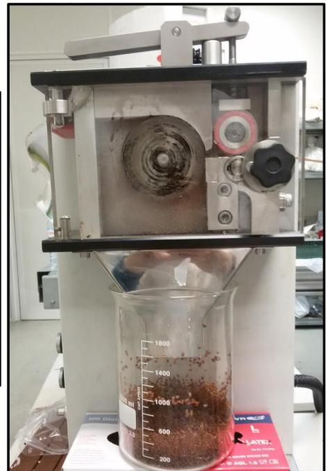
Figura 59 - Ensaio de composição dos *pellets* por extrusão.
