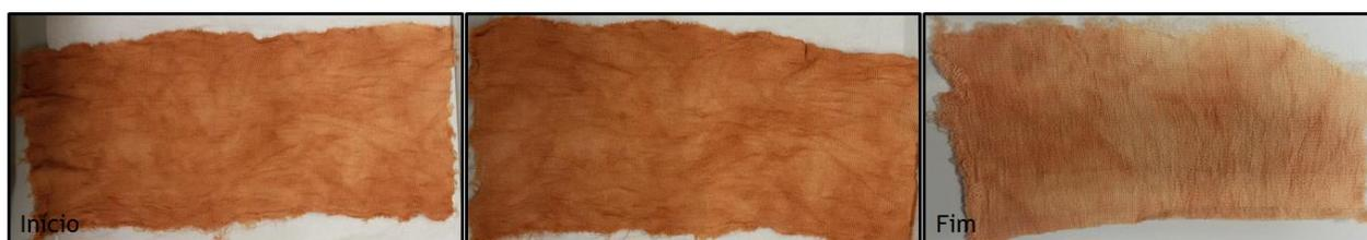
Figura 24 - Amostra de lã tingida com lama D a 10 g/L pH ácido antes e após lavagens.
