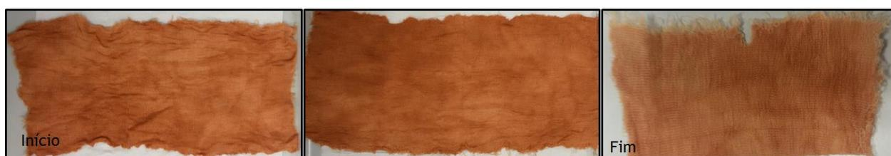
Figura 26 - Amostra de lã tingida com lama D a 50 g/L pH ácido antes e após lavagens.
