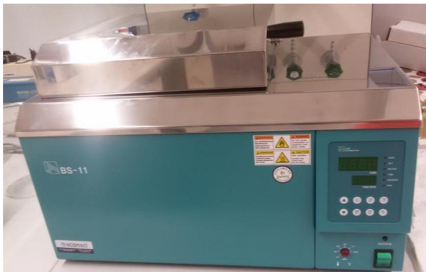
Figura 63 - Banho de agitação termostático Scansci BS-11.
