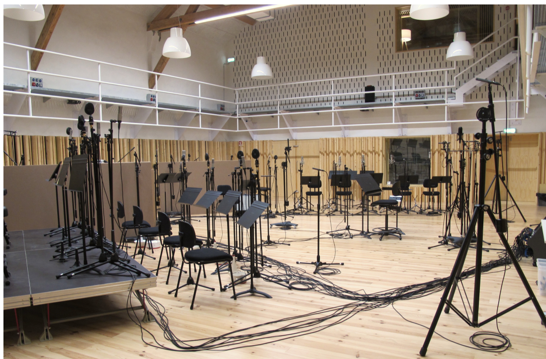
Figura 4: Stage plot com o array de captação OCT surround + 4 hipercardióides em altura e FOA Soundfield .
