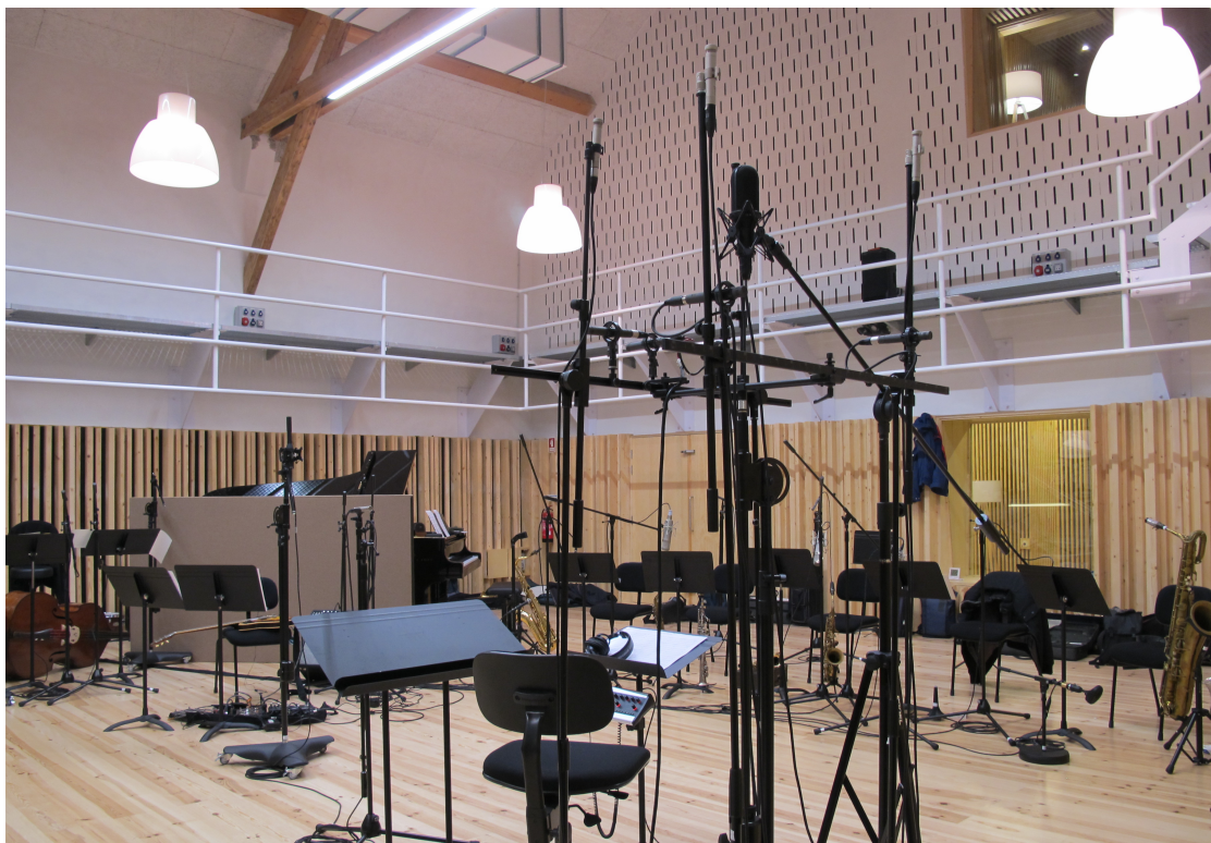
Figura 3: Array de captação OCT surround + 4 hipercardióides em altura e FOA Soundfield .
