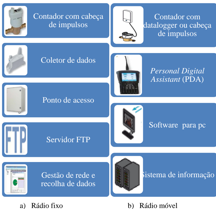
Figura 2.23 – Sistemas de telemetria: a) Rádio fixo (ITRON, 2009) e b) Rádio móvel (ITRON, 2011)
