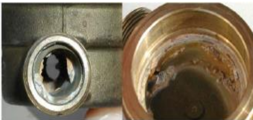
Figura 2.29 – Incrustações no interior de contadores (Arregui et al., 2005)
