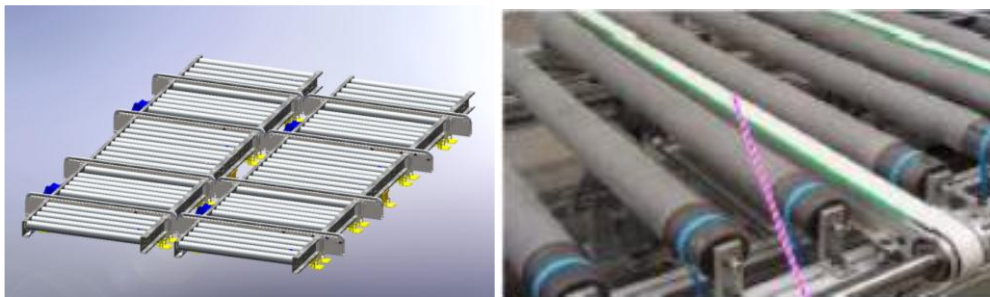
Figura F.2 - Esquema e foto de um transveyor
