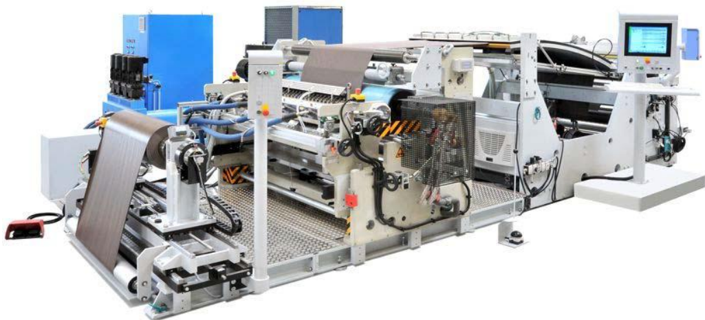
Figura 10 - Máquina de Pré-Coating (Manual técnico da Nordson)
