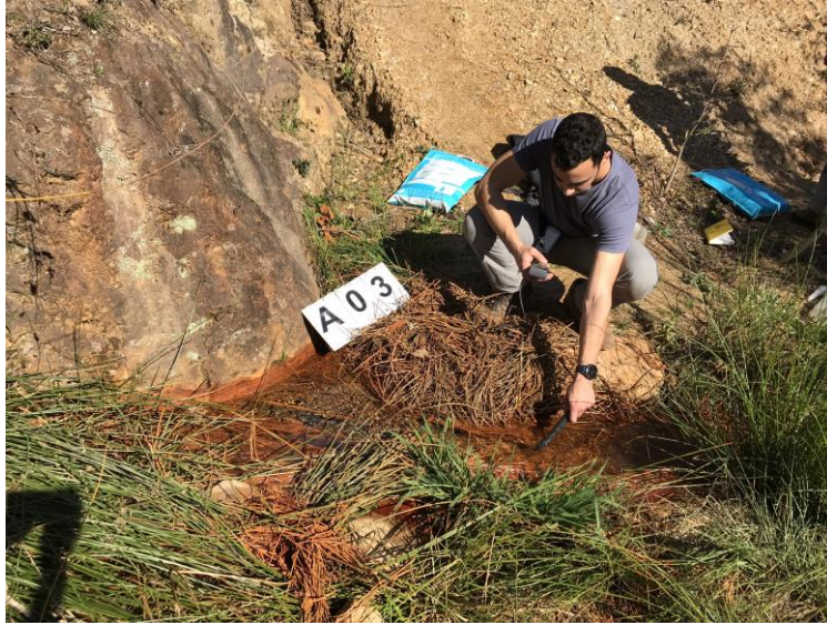
Figura 27 - Medição dos parâmetros de campo nas linhas de água.
