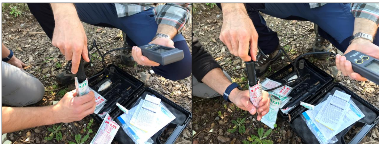
Figura 26 - Calibração do aparelho portátil com soluções padrão de pH 4 e pH 7.
