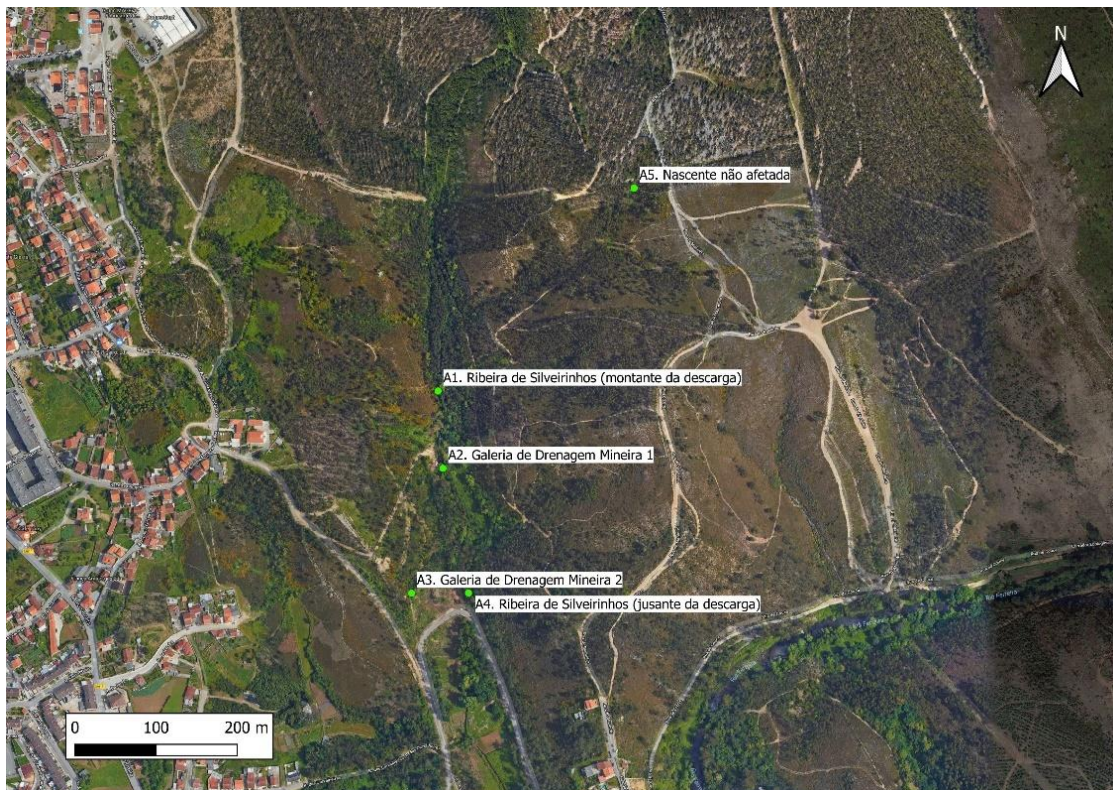
Figura 21 - Pontos de água que constituem o plano de amostragem, nas imediações do antigo Couto Mineiro de São Pedro da Cova (adaptado Google Maps, 2019).
