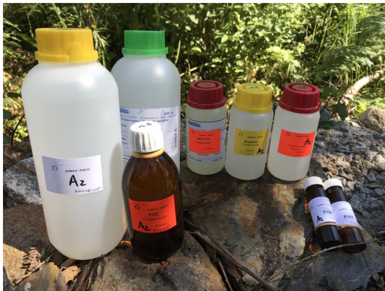
Figura 24 - Diferentes recipientes utilizados para o armazenamento da água recolhida em cada ponto de amostragem.
