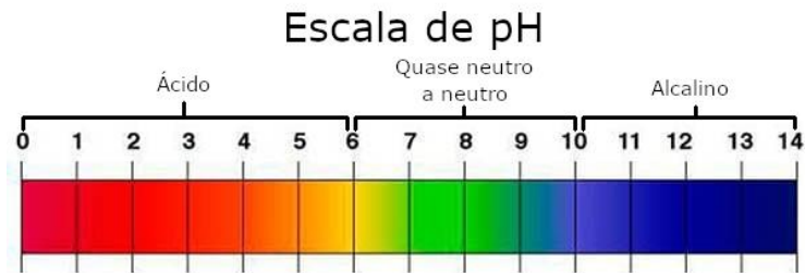
Figura 8 - Classificação de águas de drenagem mineira, utilizando a escala de pH (adaptado de Morin & Hutt, 2001).
