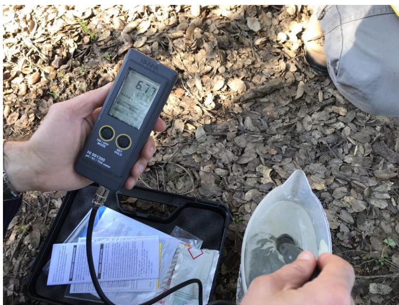
Figura 25 - Equipamento de medição de temperatura, pH e CE em água (Hanna Instruments HI 991300).
