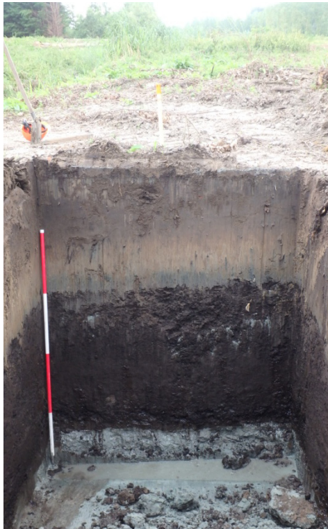
Afb. 45. Voorbeeld van een profielput waarbij het rivierzand op te grote diepte zat (put 6, noordprofiel).
