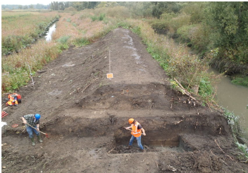
Afb. 85. Het schaven van het 11,4 m brede noordelijke wandprofiel van de smalle zomerdijk Groot Schoor naast een actieve Scheldegeul.
