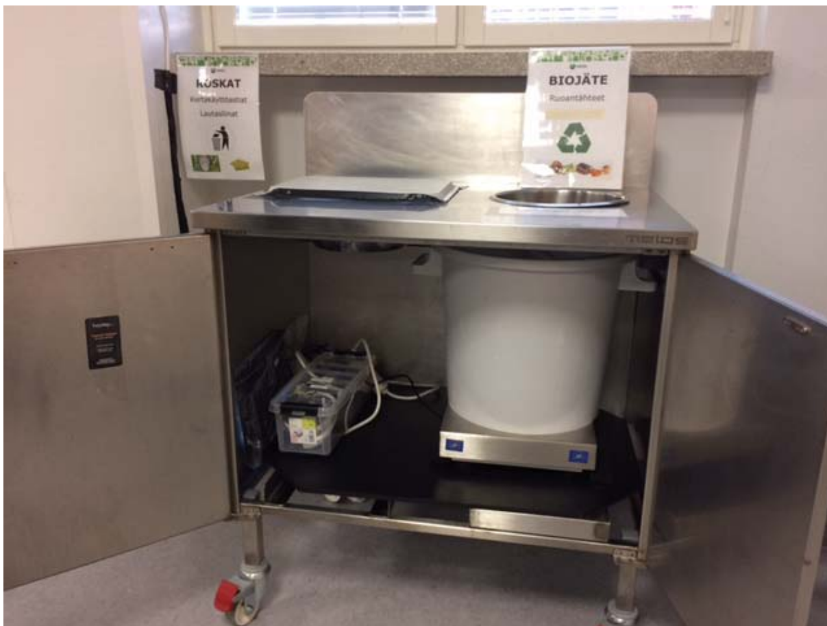
Kuva 1. Astianpalautuspisteen biojäterosiksen yhteyteen asennettu älykäs vaakajärjestelmä. Kuva: Kirsi Silvennoinen
