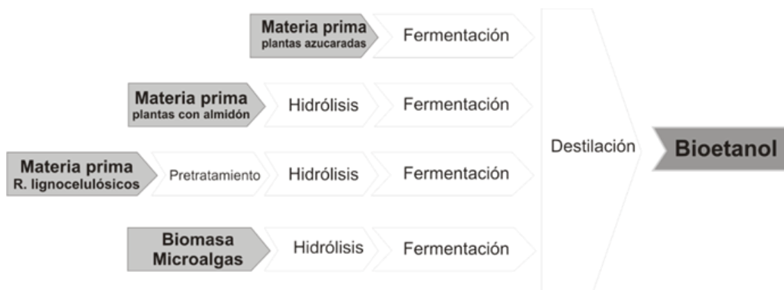
Figura 3: Procesamiento de la biomasa para producción de bioetanol. Comparación de los procesamientos de la biomasa de diferentes materias primas para la producción de bioetanol (modificado de Sanz Smachetti et al. , 2018).
