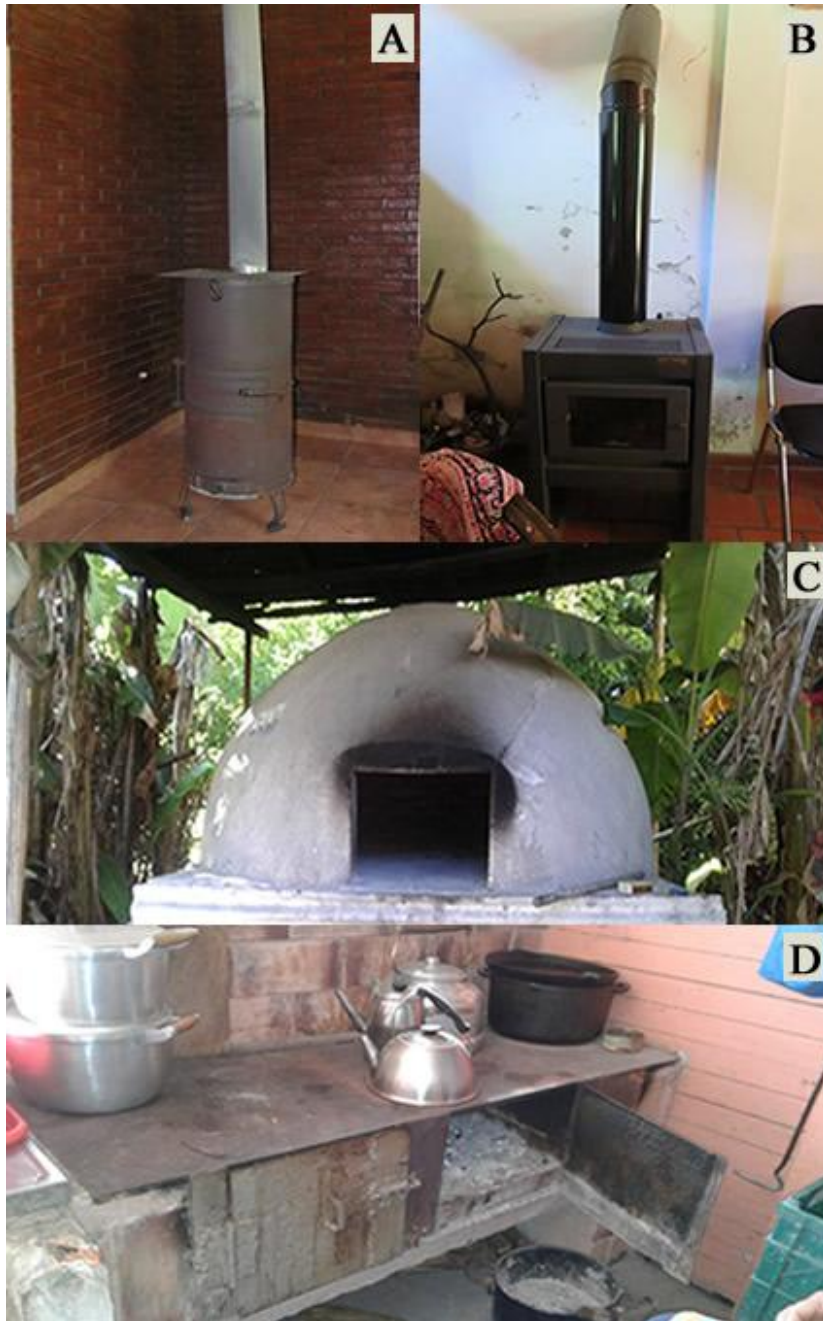
Figura 12. Artefactos empleados: A. Salamandra confeccionada de forma artesanal. B. Salamandra de doble combustión. C. Horno de barro artesanal. D. Cocina a leña artesanal.
