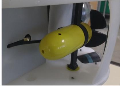
Figura 3.3: Propulsor del AUV Ciscrea
