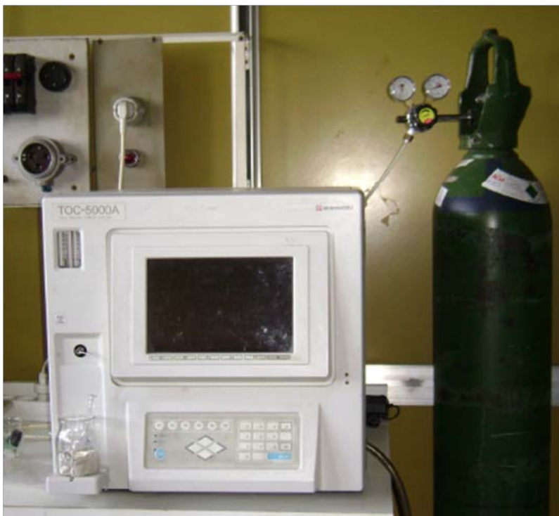
Figura 2-10. Equipo utilizado para las determinaciones de Carbono Orgánico Total.
