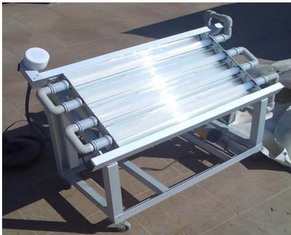
Figura 2-6. Planta piloto de fotocatalisis solar de 5L.
