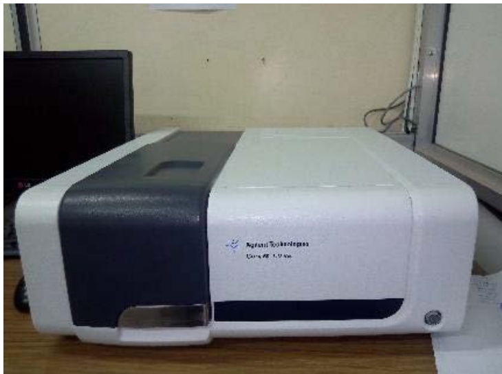
Figura 2-7. Espectrofotómetro UV-Vis Agilent Cary 60 empleado en la mayoría de las determinaciones.
