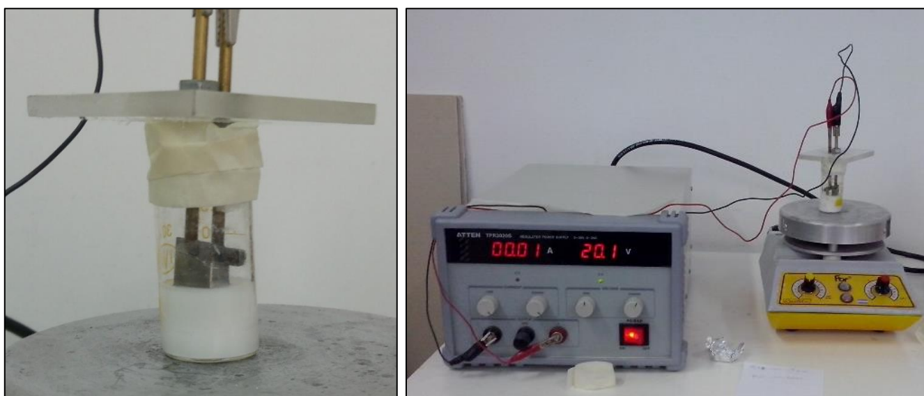
Figura 4.21. Detalles de la celda electroforética y del equipo empleado para EPD.
