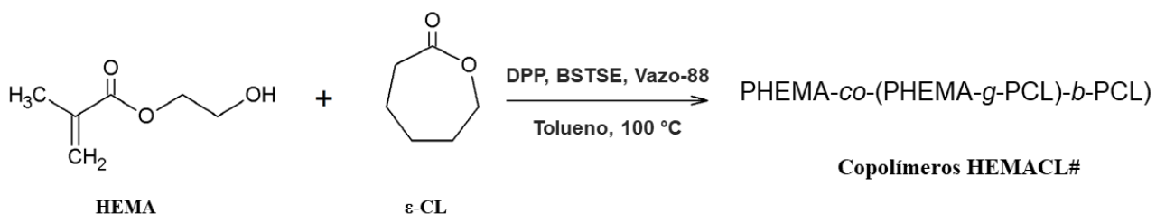
Figura 2.6. Esquema de síntesis RAFT/ROP simultánea para obtener copolímeros HEMA CL #.
