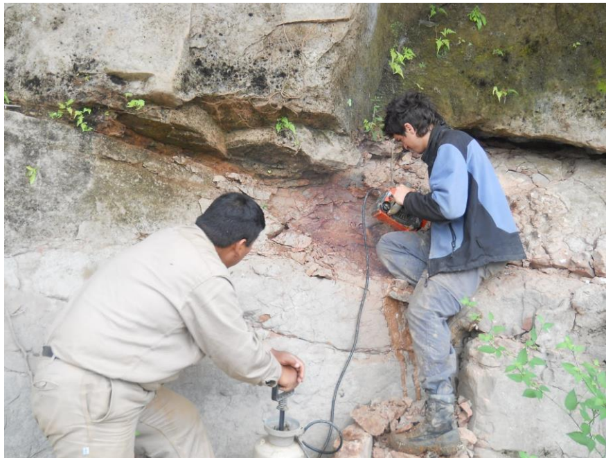
Figura 5.1 Métodos de extracción de muestras paleomagnéticas mediante perforadora portátil
