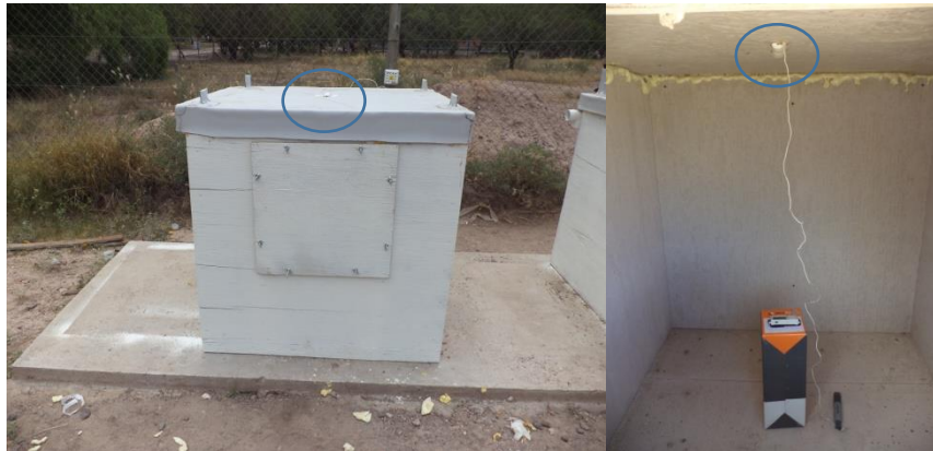
Figura 36: A la izquierda termocupla envainada colocada a nivel de membrana en la cubierta tradicional y a la derecha termocuplas tipo T incorporadas a dataloggers LASCAR ELUSB-TC en el interior de box experimental.
