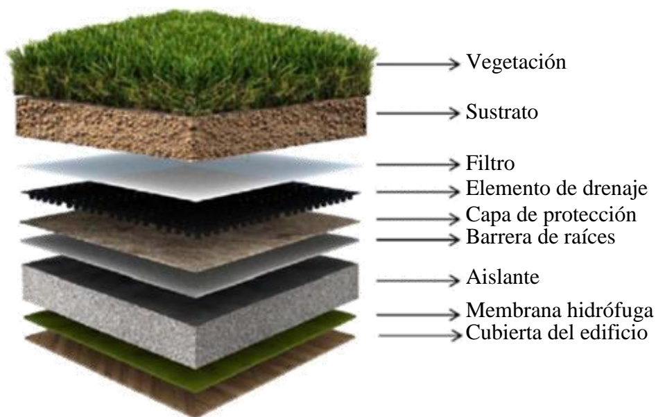
Figura 1: Esquema de diferentes componentes de cubierta vegetal. Fuente: Vijayaraghavan, 2016.
