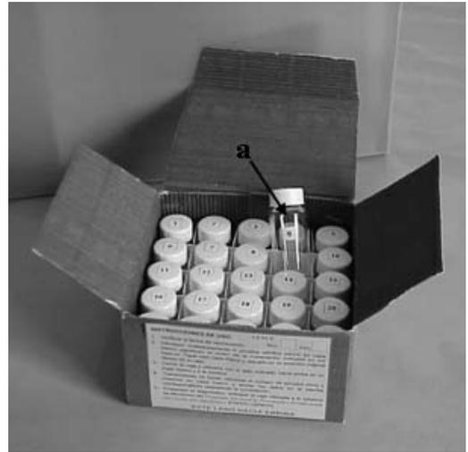
Fig. 1. “Kit” para el diagnóstico en el campo de la resistencia a insecticidas. a, viales de vidrio boro-silicato (Stadler *et al.*, 2008).
