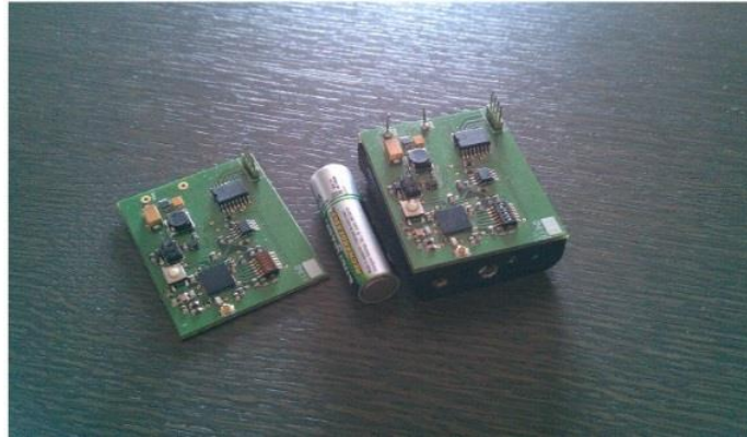
Figura 2.11 Nodo estático y nodo móvil diseñados para el test experimental.
