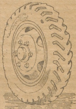
Фиг. 50. Шина грузового автомобиля Студебекер с протекторным рисунком граунд-грипп
