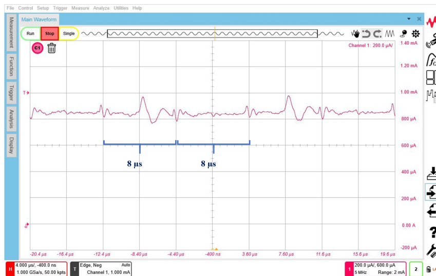
Figura 4.33: ADC a 125 kHz. “Activitat” cada 8 \mu s.
