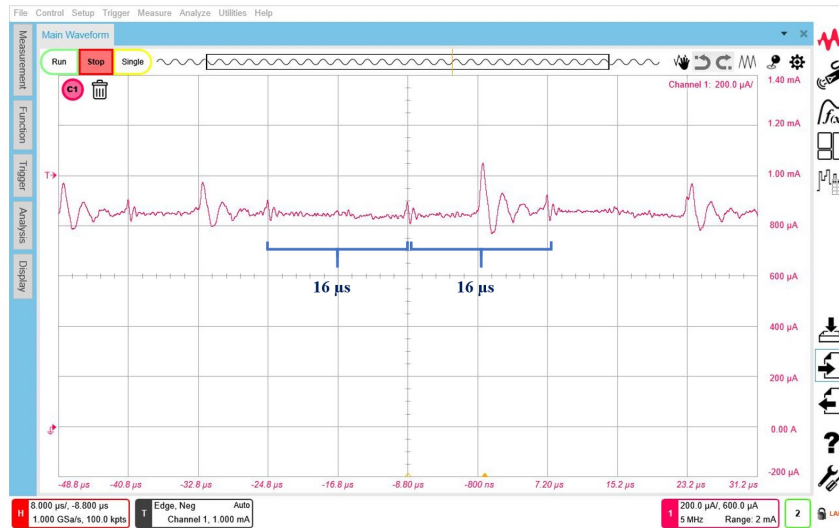
Figura 4.32: ADC a 62.5 kHz. “Activitat” cada 16 \mu s
