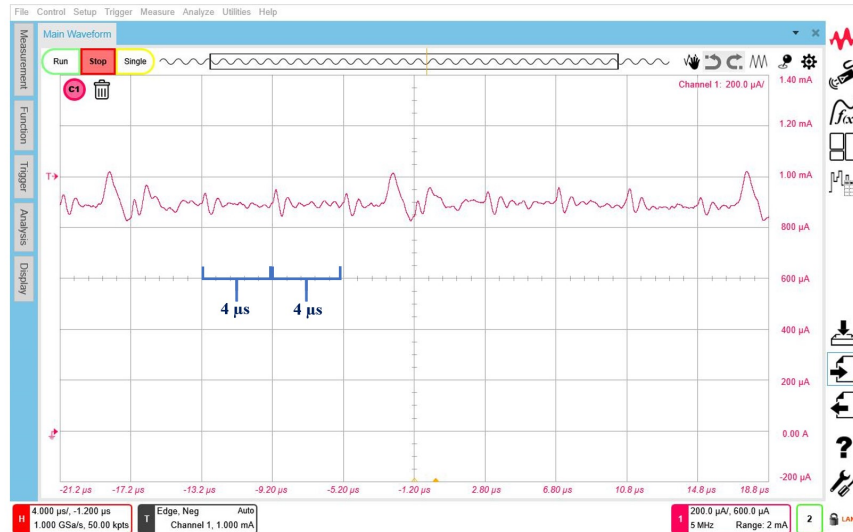
Figura 4.34: ADC a 250 kHz. “Activitat” cada 4 \mu s.
