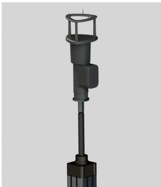
Imagen 11: Detalle del anemómetro instalado en el sistema de elevación
