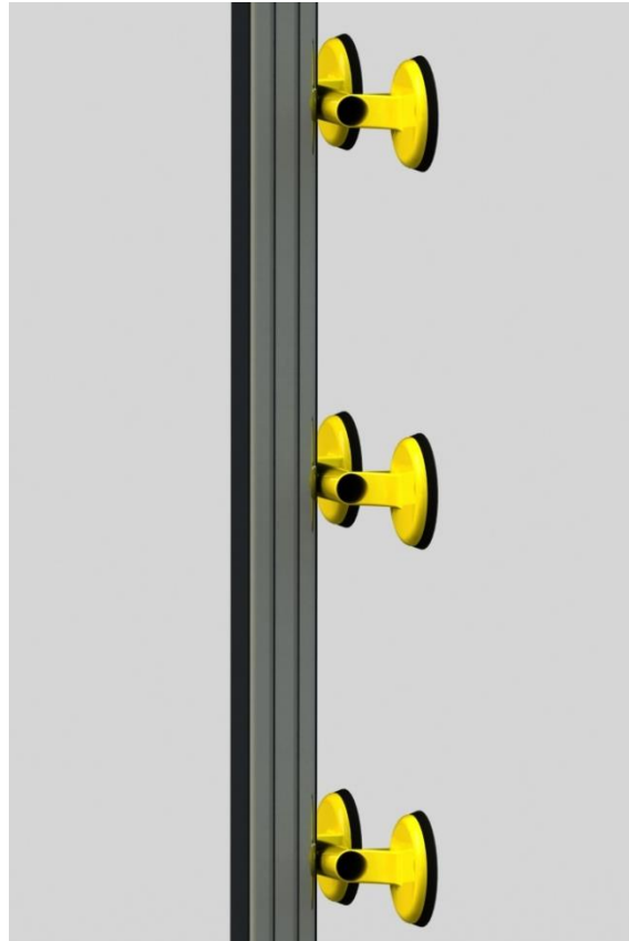
Imagen 12: Detalle de la fijación del sistema de elevación del anemómetro
