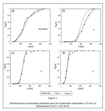
La <u>figura 7a</u> representa la granulometría de la alimentación usada para los estudios experimentales y las usadas para las simulaciones. Las figuras <u>7b</u> a <u>7d</u> representan las distribuciones acumuladas para las F1 a F3.
