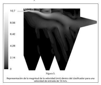
El modelo de turbulencia RSM representa los datos experimentales con muy buena concordancia y permite una visualización detallada del flujo dentro del clasificador. En consecuencia, este modelo se elige para continuar con las simulaciones.
