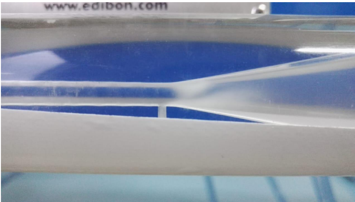
Figura 39. Estel de bombolles amb els forats aïllats amb cinta tefló
