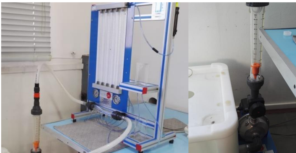
Figura 2. Cabalímetre, venturi, columnes manomètriques amb rellotges de lectura del manòmetre i del vacuòmetre i dipòsits cilíndrics (Imatge esquerra). Banc hidràulic amb dipòsit, bomba i cabalímetre (Imatge dreta).
