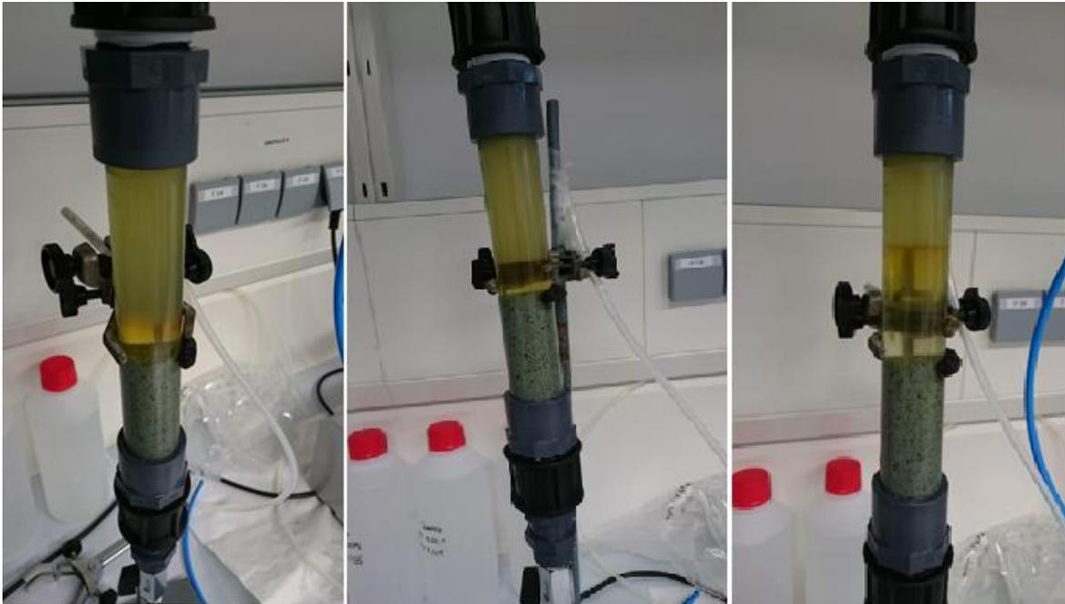
**Figura 8.** En las imágenes de la columna se aprecia el proceso de desorción en el cual, en el punto de mayor concentración, la solución se ve de color amarillo.
