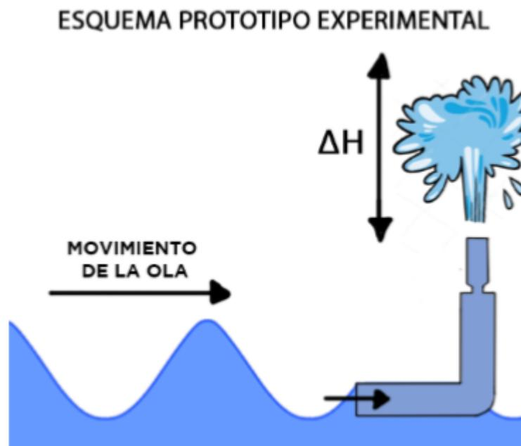
Figura 56 Esquema del prototipo experimental de Eliecer Cabrera Fernández [32].
