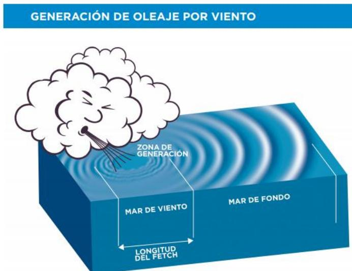
Figura 8 Esquema de las diferentes zonas que se dan en la formación del oleaje [16].
