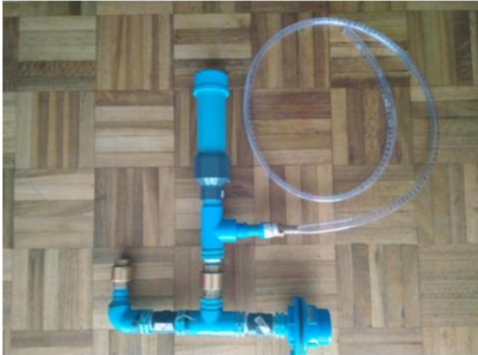
*Figura 62 Resultado de la construcción del modelo a pequeña escala con bomba de ariete de Eliecer Cabrera Fernández [32].*
