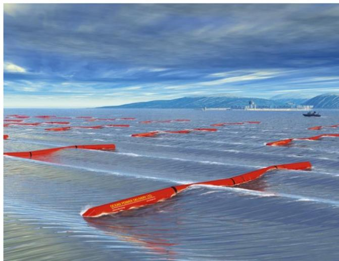
*Figura 36 Modelos virtuales de dispositivos Pelamis [37].*
