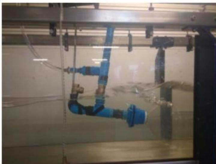
Figura 64 Ensayo del modelo a pequeña escala con bomba de ariete en el canal de olas [32].
