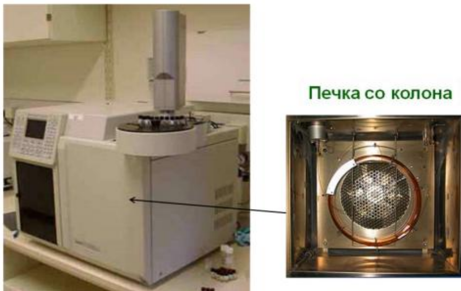
Слика 11. GC – FID инструмент и печка за колона Figure 11. GC - FID instrument and column oven
