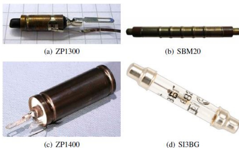
Figura 2.18: Geiger Muller utilizados en las Redes de Sensores Inalámbricas.
