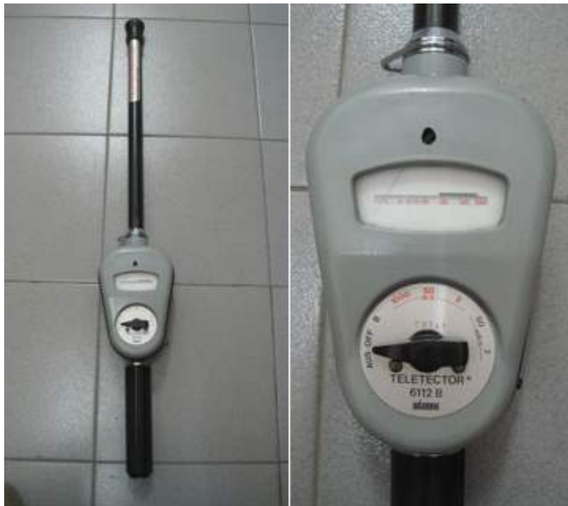
Figura 2.3: Teletector Automess utilizado para obtener los tubos Geiger Muller modelo 6112B
