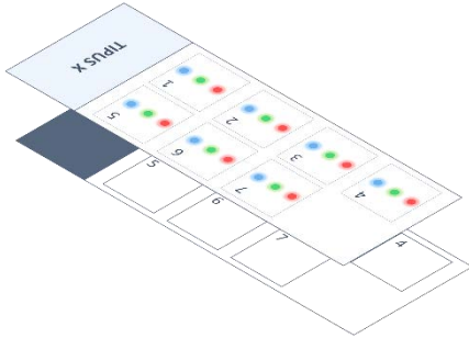
Figura 3.4 Superposició de la plantilla al portaobjectes per tal de dur a terme el procés d'hibridació.
