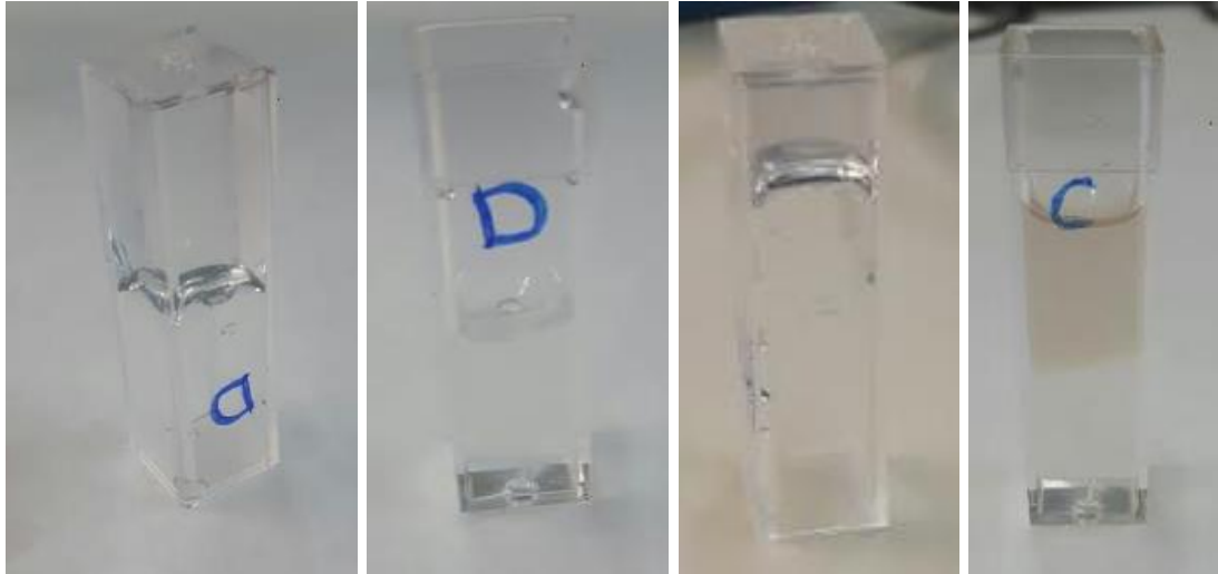
Figura 6. Cubetas con la matriz de sílice sintetizada por el método Sol-Gel.
