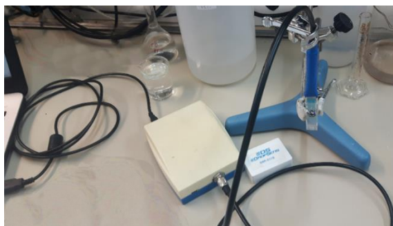
Figura 3. Potenciostato conectado al ordenador y al electrodo introducido en la cubeta.
