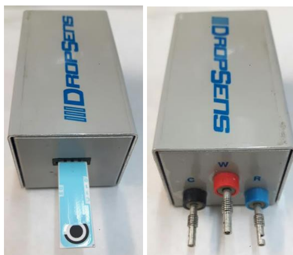
Figura 5. Conector de electrodos DropSens utilizado para el método de gotas.
