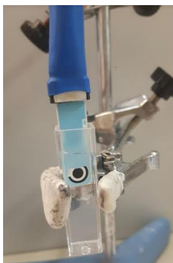
Figura 4. Electrodo introducido en la cubeta con la disolución.
