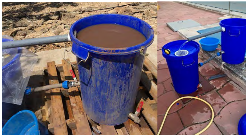
Figura 4.43: Máquina de flotar sedimento ideada por el autor en el Cerro Bilanero.
