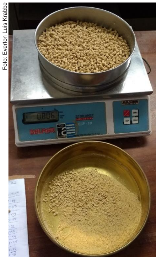
Figura 6. Determinação de percentual de finos da ração (4 mm).
