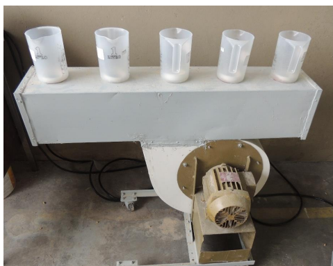
Figura 2. Equipamento utilizado para o processo de resfriamento controlado das amostras.
