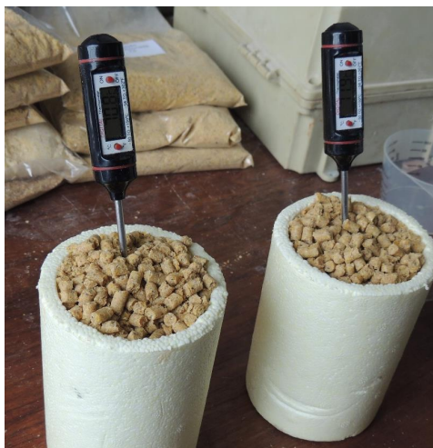
Figura 4. Termômetro de inserção para aferição da temperatura do alimento.
