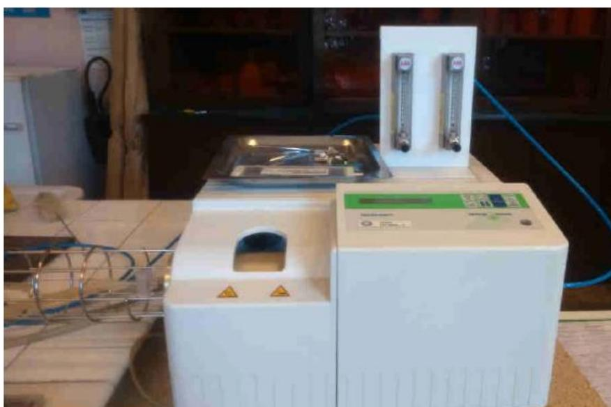
**Figura 24.** Termogravímetro (TGA/SDTA851e, Mettler Toledo).
