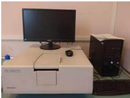
**Figura 25.** Espectrofotómetro UV-Visible (Shimadzu, UV-2401 PC).
