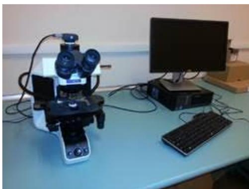
**Figura 22.** Microscopio óptico (OLYMPUS BX43F).
