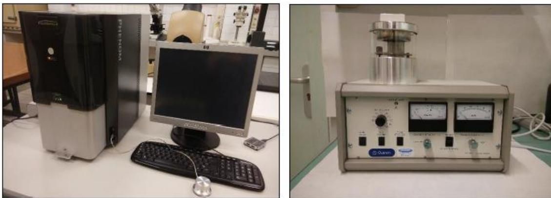
**Figura 23.** Microscopio electrónico de barrido (Phenom Standard) y equipo de recubrimiento (SC7620, Quorum technologies).
