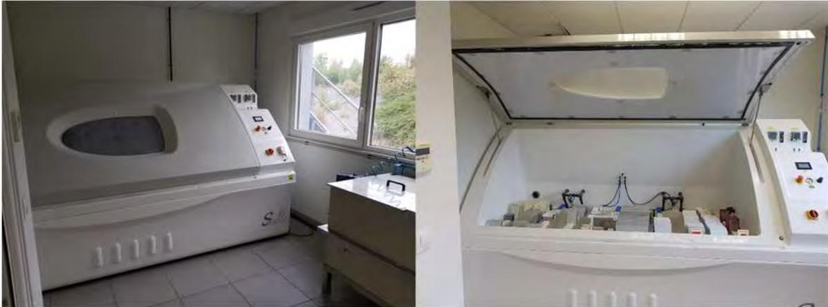
Figure 36 : Enceinte de corrosion accélérée sous brouillard salin neutre
