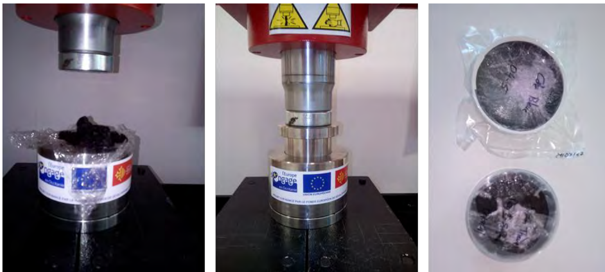
Figure 3.8 : Illustrations de la mise en boîte d'un échantillon pour analyse Gamma
