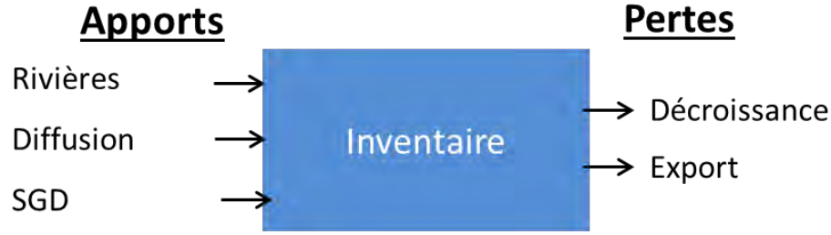
Figure 2.7 : Schéma du bilan de radium (applicable aux lagunes côtières, aux baies ou au domaine côtier)
