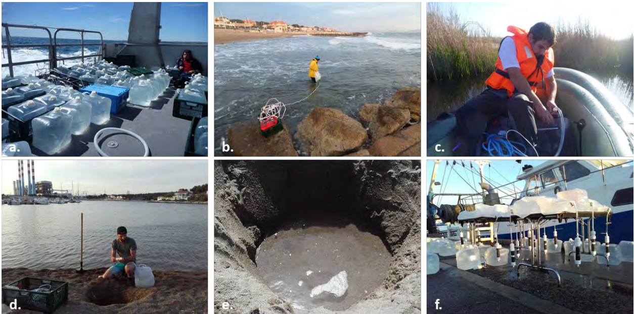
Figure 3.2 : Illustration des différents types d'échantillonnages réalisés au cours de cette étude : a. Eau collectée en mer à bord de l'Antedon II ; b. Eau collectée en bord de plage (Côte Bleue) ; c. Eau collectée dans l'étang de Salses-Leucate ; d. et e. Prélèvements d'eaux interstitielles (Baie des Laurons) et (f.) passage des échantillons sur fibre Mn
