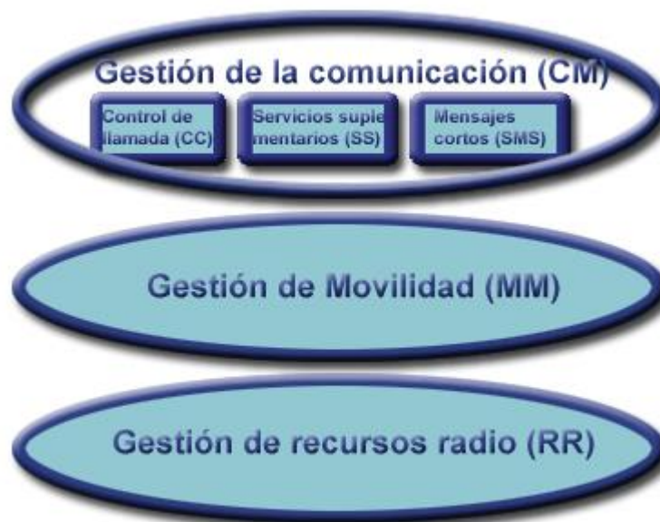
Figura 2.16: Capas de la señalización de GSM
