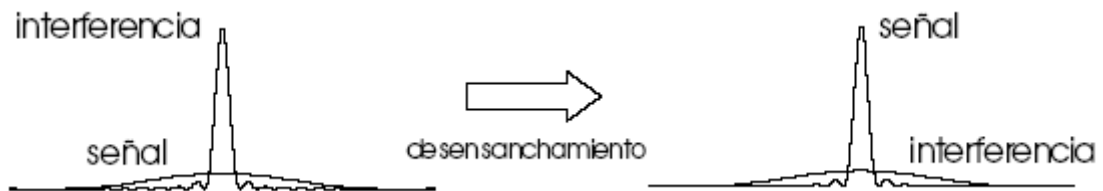
Figura 2.30: Protección contra interferencias de banda estrecha
