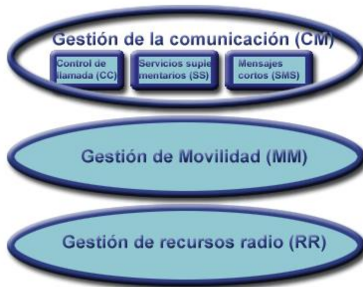
Figura 0.68: Capas de la señalización de GSM
