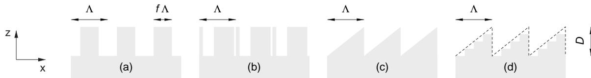
Bild 3: Typen oberflächenkorrigierter Gitter: binäres symmetrisches Gitter (a), binäres asymmetrisches Gitter (b), geblatztes Gitter oder Echelette (c) und Stufengitter (d).
