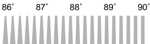
Bild 23: Flankenform für verschiedene Flankenwinkel für Gitter mit  $f = 0,49$ .
