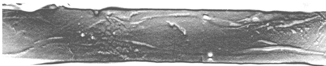
**Abb. 4.4 Topogramm des sphärisch gebogenen Quarz Kristalls.**
