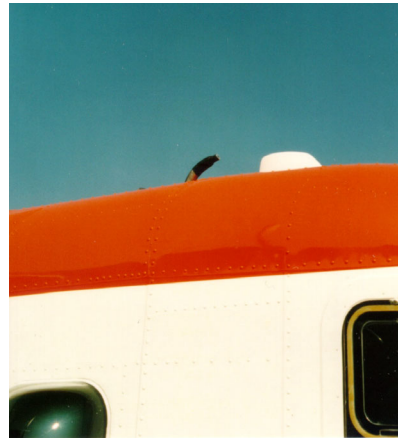
Abb. 3-13 Einbau des TEKRAM 2537A, der Gasversorgung und der Probeneinlassleitung in eine Dornier 228.
