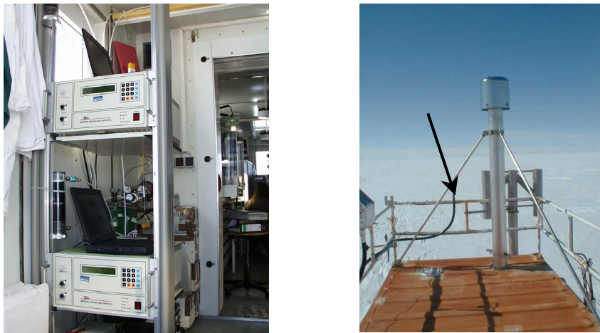
Abb. 3-11 Einbau von zwei TEKRAN 2537A im Chemischen Spurenstoffobservatorium der Neumayer-Station und der Probennahmeleitung auf dem Dach des Containers (Pfeil).
