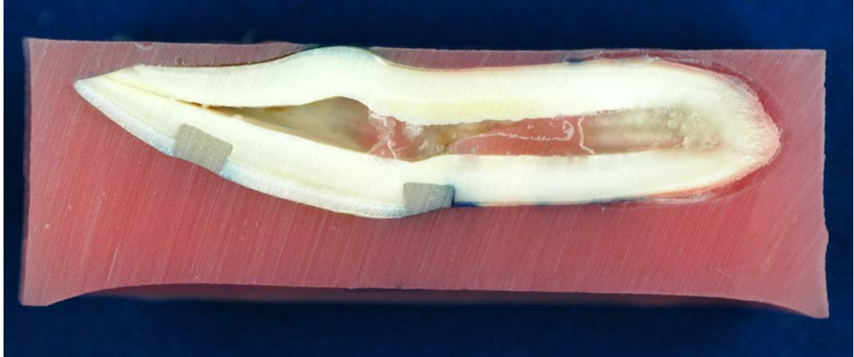
Abb. 1 Prüfkörperherstellung für die Microleakage-Prüfung
