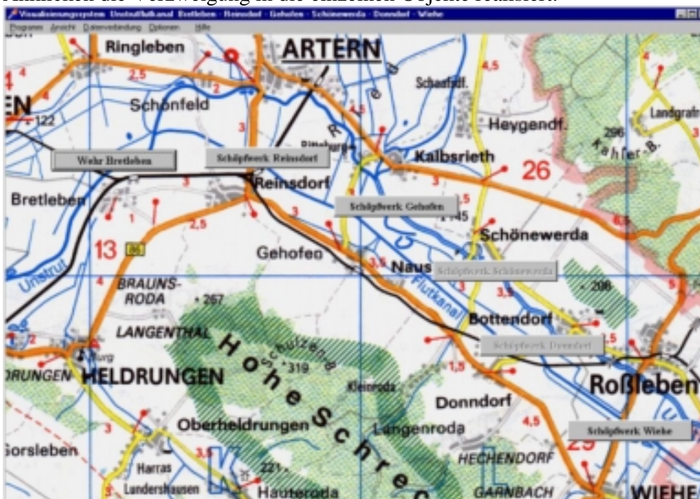
Bild 6.1 Visualisierungsplattform des Fernwirksystems für Hochwasserschutz
