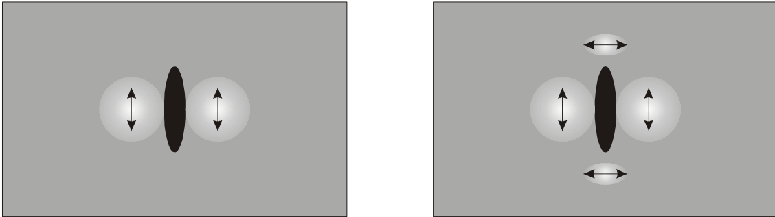
Abb. 2.1.4: Prinzipdarstellung der lichtführenden Bereiche bei Wellenleitern auf Basis von kristallinem Quarz: Die Pfeile geben jeweils die geführte Polarisationsrichtung an. Den "Normalfall" stellen zwei symmetrische Bereiche dar, die horizontal neben dem Kern liegen (linke Abbildung). Nur wenn die [00.1]-Richtung des Kristallgitters horizontal liegt tritt zusätzlich Lichtführung in kleinen Bereichen ober- und unterhalb des Kernes auf (Abbildung rechts).
