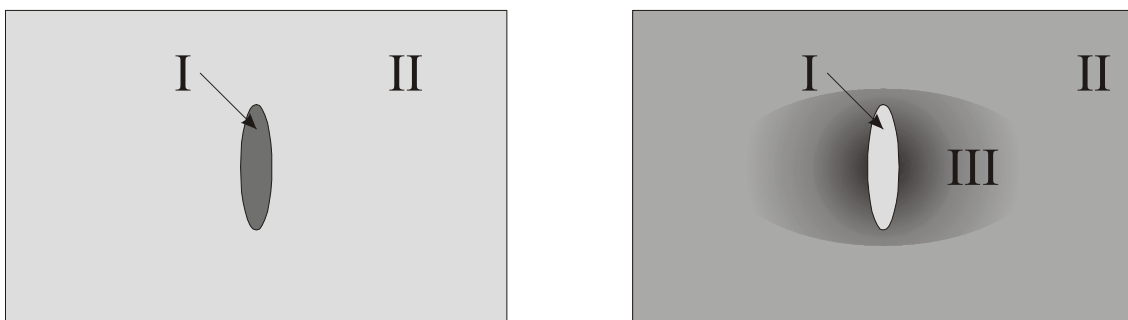
Abb. 3.1.1: Veranschaulichung der unterschiedlichen Konfiguration der Wellenleiter: Im Quarzglas (links) wird das Licht im Bereich I geführt, wogegen die Führung im Quarzkristall (rechts) im Bereich III erfolgt.
