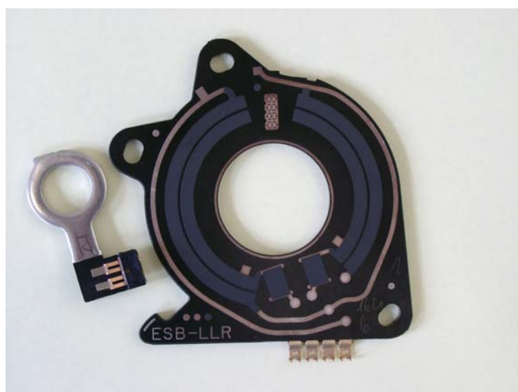
Abb. 3.1.4-5 Regelbarer Widerstand (Abstandssensor) mit Sol-Gel-Widerstandsbahn (blaue Streifen auf Substrat)
