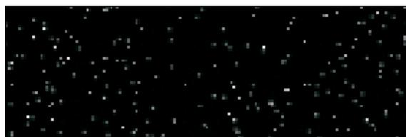
Abbildung 3.7: Ausschnitt von  $50 \times 100$  Pixeln aus einem typischen CCD-Signal. Die Graustufen kodieren die im Pixel deponierte Photonenenergie.
