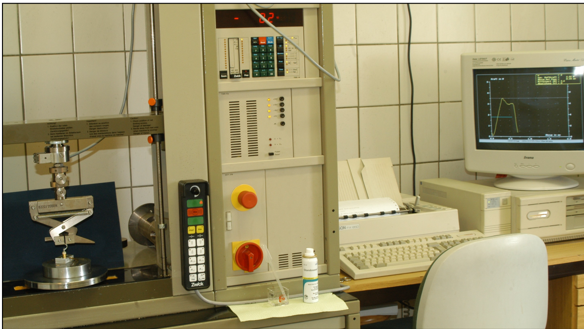
Abbildung 4. Versuchsanordnung in der Universalprüfmaschine „Zwick 1435“.
