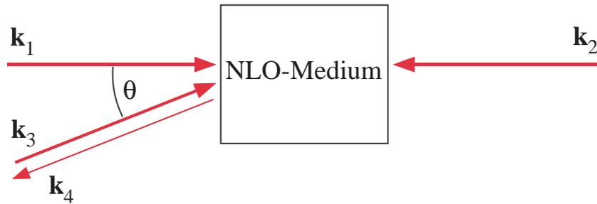
Abb. 3.6: Rückwärtsgeometrie für die entartete Vierwellenmischung.
