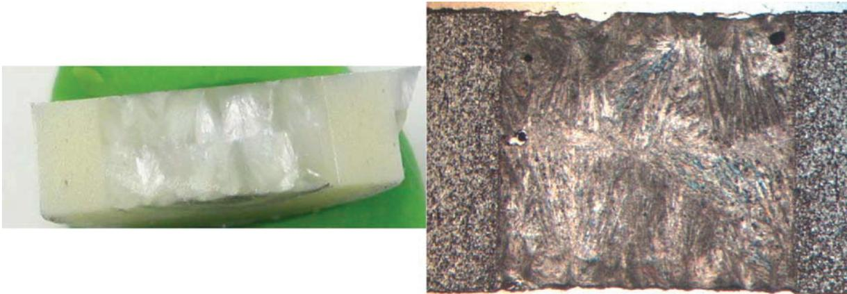
Abbildung 18: Optische Aufnahmen der Probe B2-5,0 nach Leitfähigkeitsuntersuchung abgekühlt mit 0,167 K/min. Schnitt senkrecht zu den Elektroden (Elektroden befanden sich oben und unten) links Fotografie, Probe im linken Bild 10mm Durchmesser, rechts Durchlichtfotografie, Probe ca. 4mm
