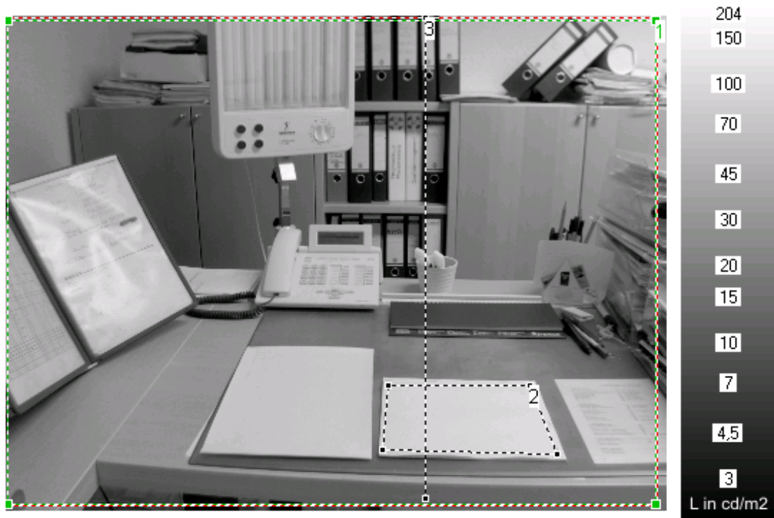
Abb. 5: Verteilung der Leuchtdichte im Arbeitsbereich (Büro 1)
