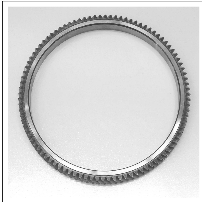
Bild 39 verwendeter Zahnradtyp, schrägverzahnt, 96 Zähne
