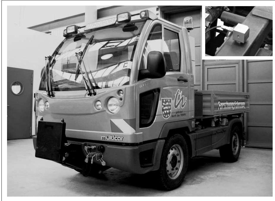
Bild 86 Forschungsfahrzeug Multicar M 30 und Beschleunigungssensor
