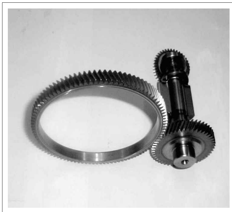
Bild 3 Zahnkranz und eine Ausgleichswelle eines 4 Zyl.-Otto Motors
