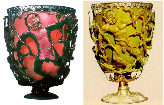
Abbildung 1.1: Der Lycurgus-Kelch aus dem 4. Jahrhundert nach Christus (British Museum, London). Die Farben des Glases stammen von in Gold-Nanopartikeln angeregten Teilchen-Plasmonen. In Transmission leuchtet das Glas rot, im Streulicht schimmert die Oberfläche grünlich.
